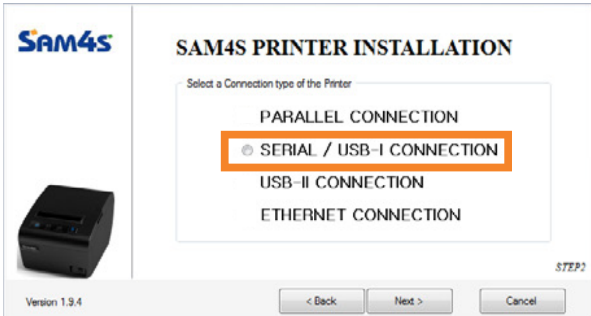
Imagen 15. Escogemos el puerto SERIAL para la instalación con Drivers por puerto COM.
